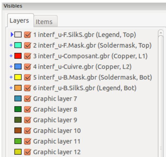
La gestione strati controlla la visibilità di tutti gli strati. Una freccia indica lo strato attivo, ed ogni strato può essere mostrato o nascosto tramite le caselle a spunta.
